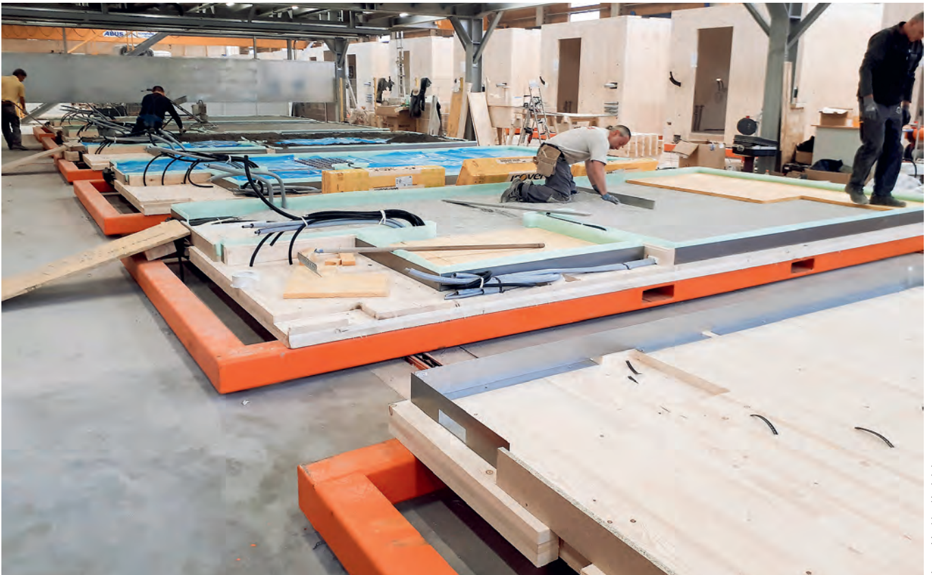
Kuva 9. Tilaelementtien lattiatasojen tekoa Itävallassa.
