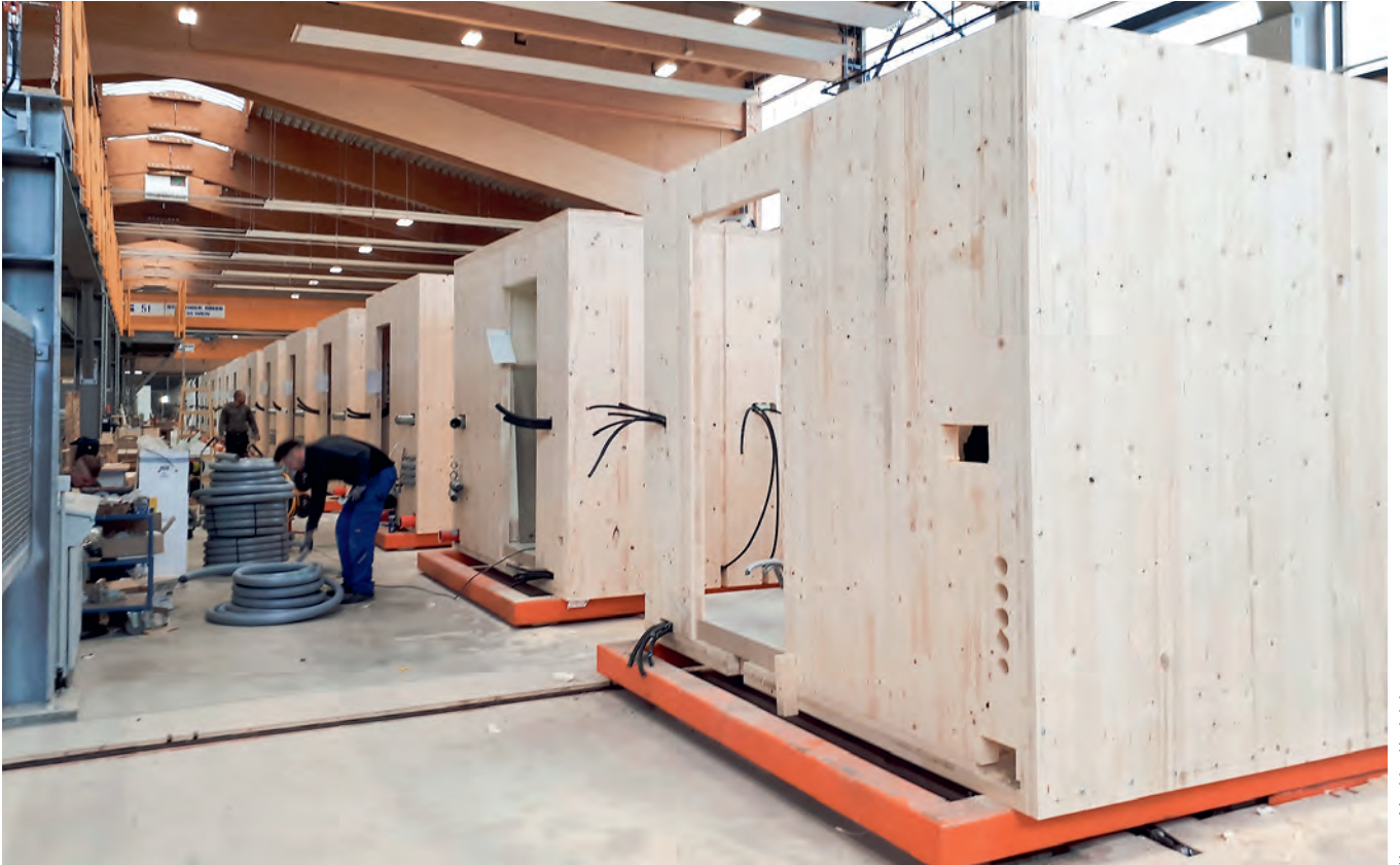
Kuva 8. CLT-runkoisia tilaelementtejä valmistetaan suureen opiskelija-asuntolakohteeseen Itävallassa.
